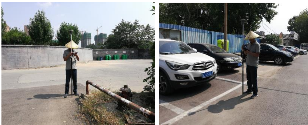
图 5.3-2 现场基准点校正
