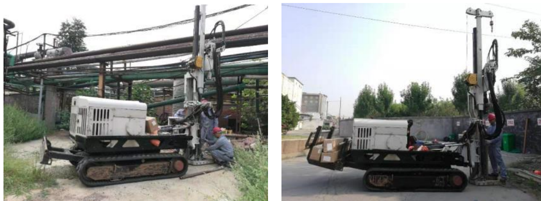
图 5.3-5 Geoprobe 系统平台专业钻探设备
